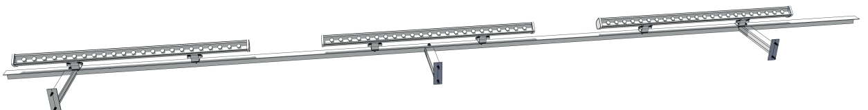
Soporte para iluminación lineal - Torre de agua Distancia aproximada entre ménsulas: 1,56 m Cantidad de soportes: 4 - (Longitud aprox.: 5,40 m) NOTA: Los encuentros entre perfiles de aluminio serán en inglete.
