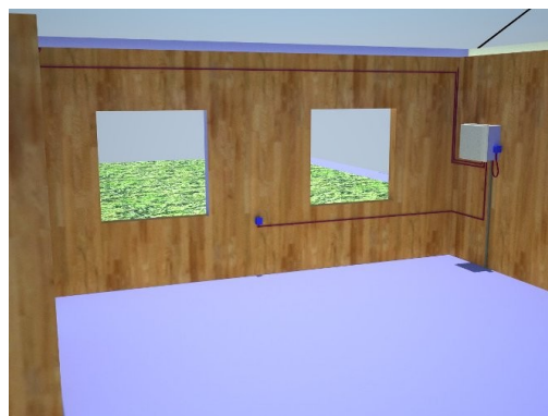
Figura 2: Acceso al punto de suministro normalizado, donde se puede visualizar la caja estanca prevista para la acometida.
